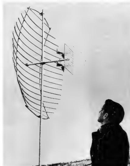
Hochleistungs-UHF-Breitbandantenne Modell Para Scope
