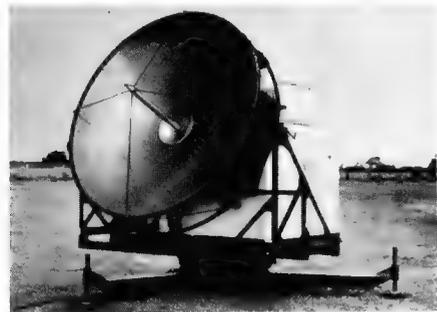
Windgeschwindigkeit und -Richtung bis zu einer Höhe von 30 km zeigt das Decca-Windmeßradar WF 2 an. Die Antenne und die wohnwagenähnliche Kabine sind auf einem Drehtisch montiert. Die Steuer- und Meßgeräte können von einem Mann bedient werden
